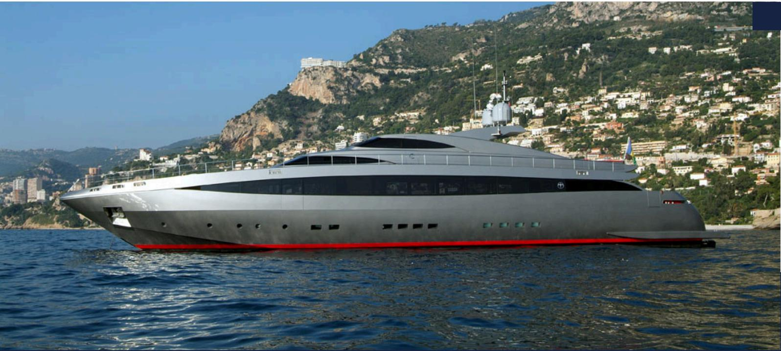
Progettata da Tommaso Spadolini e consegnata nel 2005 Nina J. si avvale di una linea con cavallino rovescio, completamente wide body. La colorazione è di un discreto grigio argento e presenta sopra alla sovrastruttura del ponte superiore una capsula di pilotaggio. Costruita in alluminio e motorizzata una copia di Mtu e di idrogetti KaMeWa raggiunge una velocità massima di 32 nodi.
