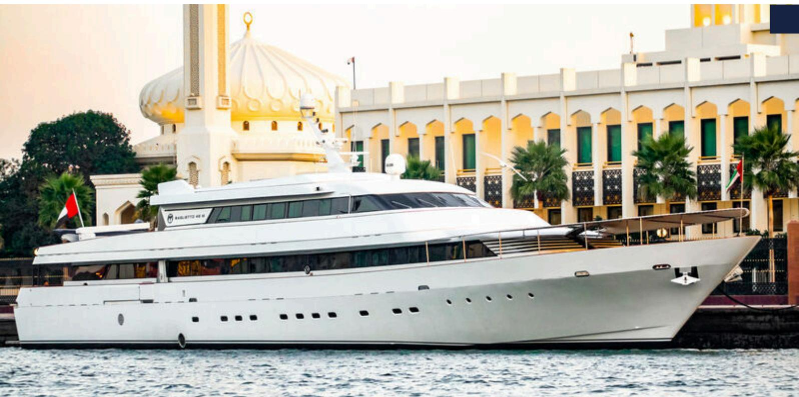
Nel 1986 a Baglietto occorre l'occasione di costruire il suo più grande yacht, una nave di 46 metri semi planante con scafo in acciaio e sovrastruttura in alluminio, che viene stilizzata e arredata dall'architetto Gianni Zuccon dello studio Zuccon International Project.
